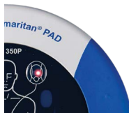
10. ábra Villogó piros fény és/vagy sípolás; Lásd a Hibaelhárítás részt a B. függelékben.
